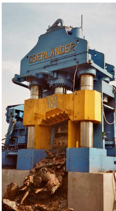
Abb.: Die markante Säulenführung der Oberländer-Scheren
