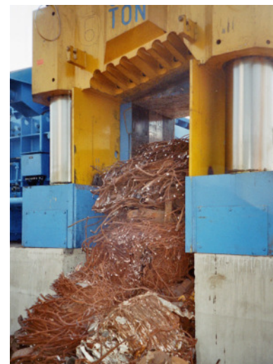
Фото: Даже арматурная сталь не является проблемой для этих ножниц
