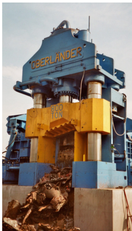
Фото: Характерные для пресс-ножниц марки Oberländer цилиндрические направляющие.
