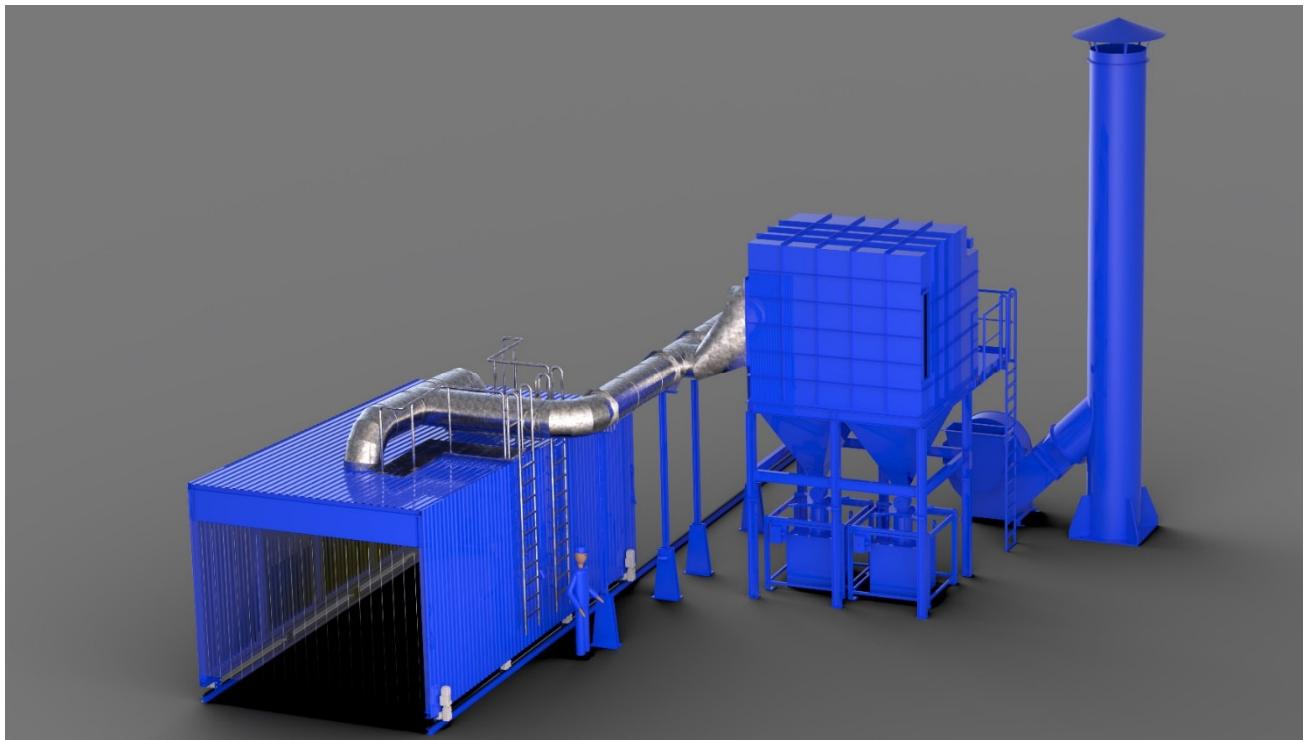
Hall d'extraction mobile de type BH 8x4 avec système de filtrage fixe pour collecter les fumées provenant des opérations d'oxycoupage.
