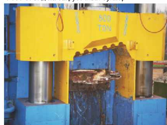
Фото 4: Вид на салазки ножей с цилиндрическими направляющими
