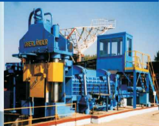
Фото 1: ножницы для резки лома ORM 800 т, тип HY-PS 800
