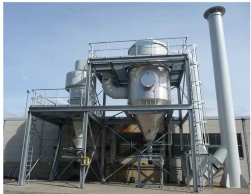
Рис. 4: система очистки отработанного воздуха в соответствии с АТЕХ
