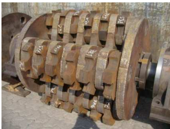
Рис. 3: Ротор дробилки с ударными кольцами
