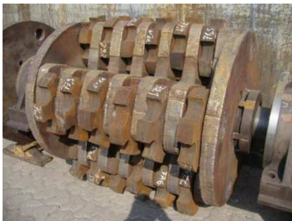
Bild 3: Shredder Rotor mit Schlagringen
