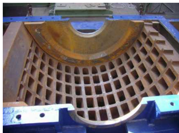
Bild 4: Blick auf geöffnetes Shredder-Unterteil mit Rost
